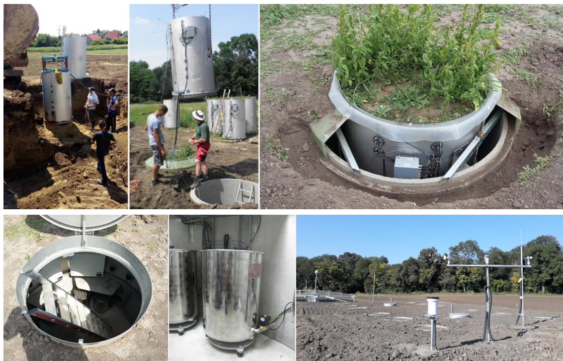
3.14 ábra: Felső sor: a liziméter állomás telepítése; Alsó sor: az adatgyűjtőket és a csurgalékvíz-gyűjtőket tároló akna; mérlegre állított csurgalékvíz-gyűjtők; és a saját meteorológiai állomással rendelkező, 'készre szerelt' liziméter állomás, Martonvásár, 2017.
