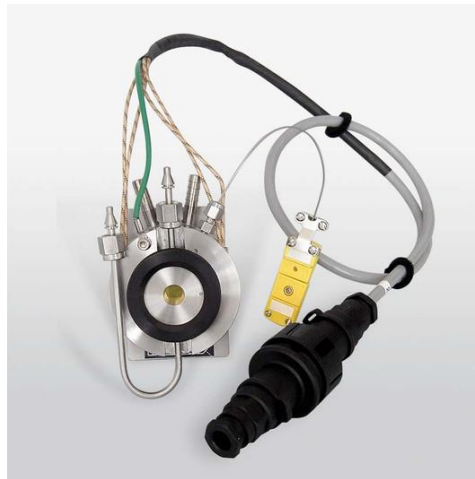
2.13 ábra A bal oldalon az infravörös tranziens abszorpciós rendszerben használt mintatartó látható, a jobb oldalon egy termosztálható Harrick mintatartó látható.
