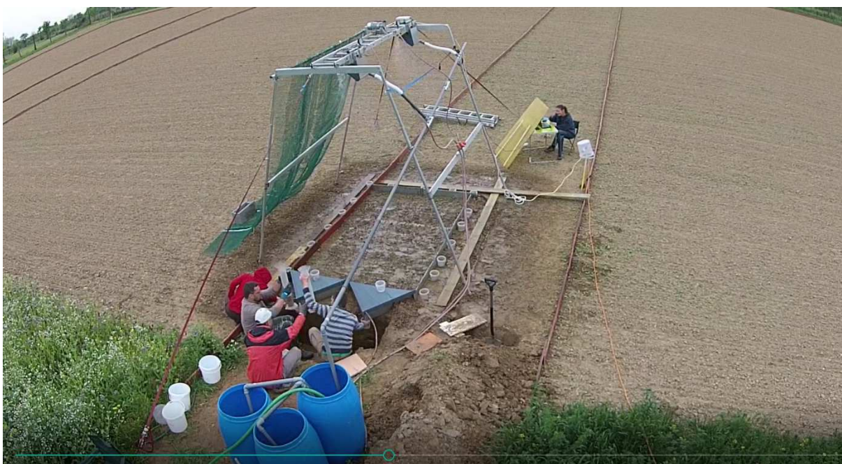
8. ábra Az általunk fejlesztett „Shower Power 02” terepi esőszimulátor a magágy állapotú talaj esőztetése közben a Szentgyörgyvári Kísérleti Állomáson 2016 májusában
