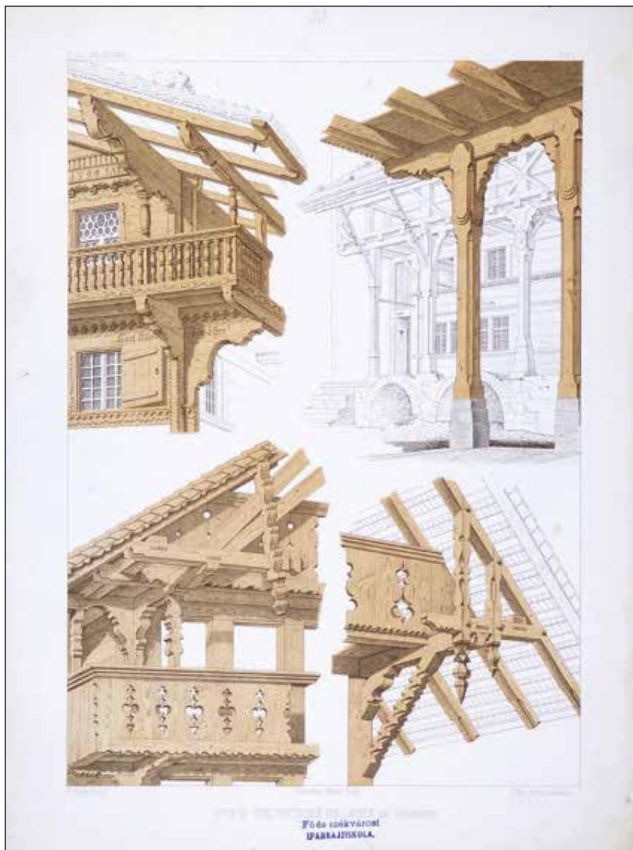
46. kép: Ernst Gladbach: Der Schweizer Holzstyl... 1868-ban megjelent munkájának egy lapja. (Chromolithographia, Gladbach, Ernst és F. Wirtz. Lith. Anstalt Darmstadt: “Stuetz-Constructionen der Lauben und Vordächer,” Schola Graphidis Art Collection) 422
