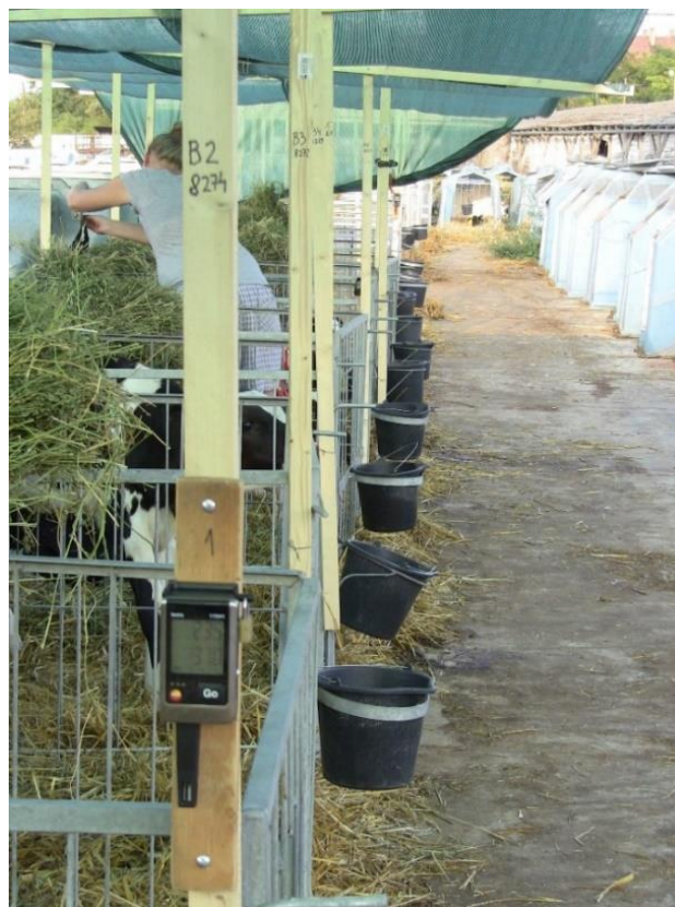
A környezeti hőmérséklet és páratartalom mérése Testo 175H1 műszerrel. Fotó: Dr. Kovács Levente
