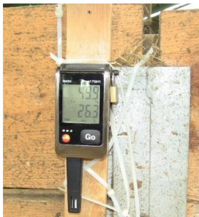
14. ábra: A közlekedőút mellett elhelyezett Voltcraft DL-181THP (a) és a pihenőbokszon rögzített Testo 175 H1 (b) hőmérséklet-páratartalom-mérő szenzorok
