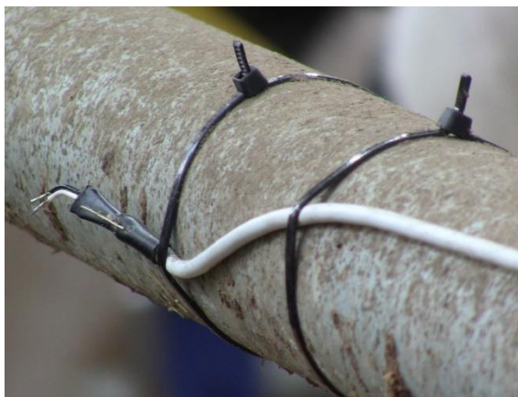
14. ábra: A közlekedőút mellett elhelyezett Voltcraft DL-181THP (a) és a pihenőbokszon rögzített Testo 175 H1 (b) hőmérséklet-páratartalom-mérő szenzorok
