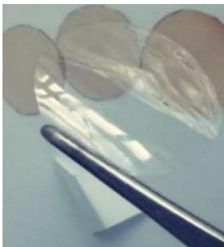
19. ábra – Egy elkészült támasztóréteges ionos folyadékos membrán képe [5]
