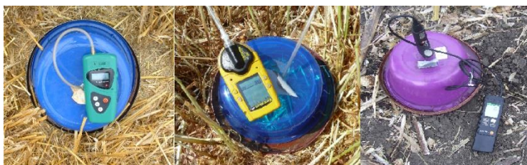
2. ábra: A szántóföldi körülmények között használt fémkeret és a műanyag mérőedény a gázanalizátorokkal (Anagas CD 98, Gas Alert Micro 5w, Testo 535)
