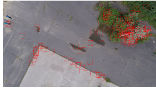
(a) 250 darab SIFT [Low04] jellegzetes pont követése
