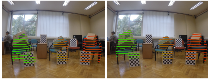
45. ábra. A visszavetített doboz és sakktáblapontok a 44. ábrán látható tesztesetről. A Geiger és munkatársai módszerével [53] becsült kamera paramétereket a bal oldali eredményén használtuk, a javasolt módszer eredménye a jobb oldalon látható.
