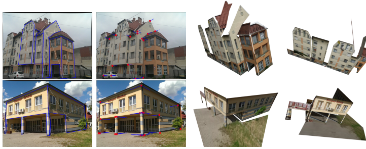
37. ábra. Épületrekonstrukciós példa. Balra a kiválasztott felületdarabok láthatóak, mellettük a rekonstruált pontok és normálvektorok a képre vetítve. A jobb oldali képeken két különböző nézetből láthatóak a rekonstruált térbeli felületek.
