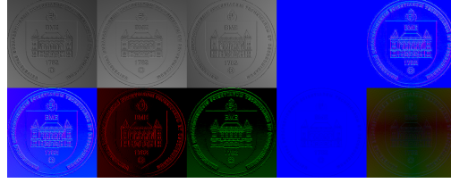
33. ábra. Felső sor: 8-ból 3 renderelt kép a "BME logo" szekvenciából, a kezdeti normáltérkép és az alpnormálok. Alsó sor: Rekonstruált normáltérkép, annak R, G, B komponensei és a normáltérkép hibaképe.
