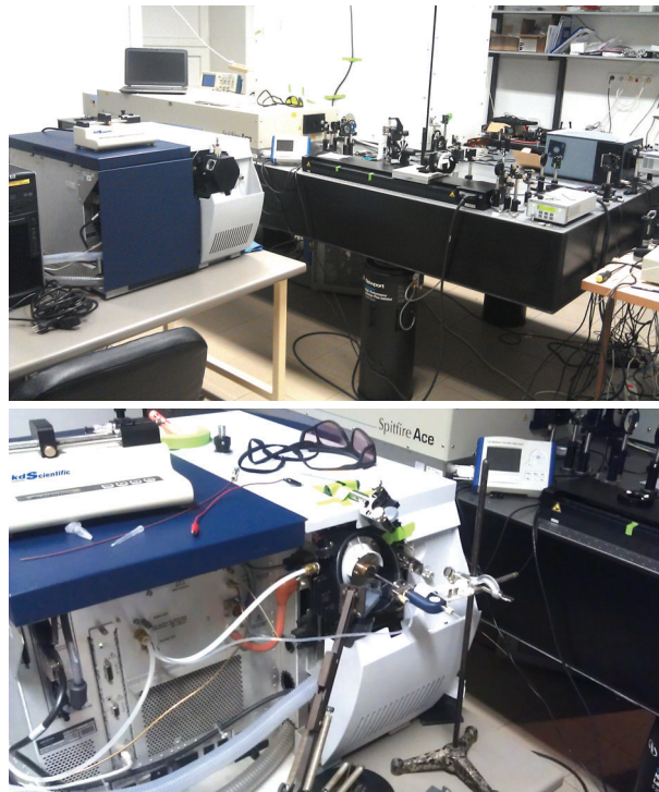
111. ábra: A munkacsoportom által megépített fsLAESI rendszer kísérleti elrendezése.
