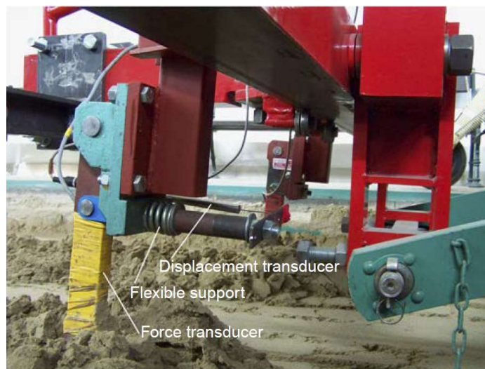
2.18. ábra: Talajművelő szerszám rugalmas rögzítése
