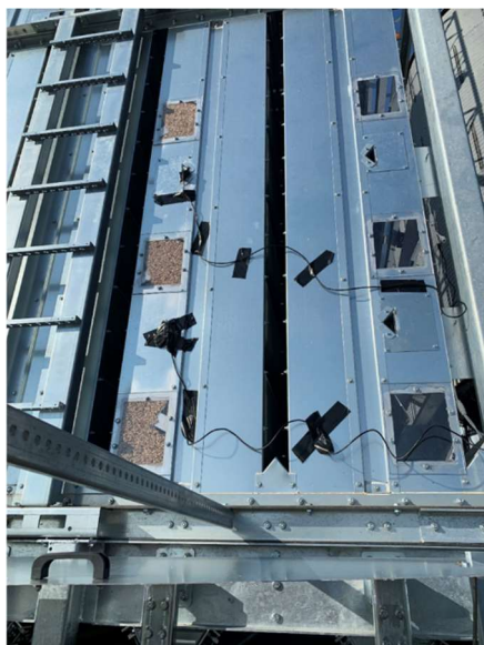
2.28. ábra: Betekintő ablakok és endoszkóp kamera szondanyílások a szárító modulon
