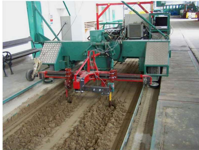
2.17. ábra: Összehasonlító vonóerőigény mérés a NAIK MGI talajvályójában
