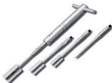
2.9. ábra: Torziós elven működő talajnyíró készülék
