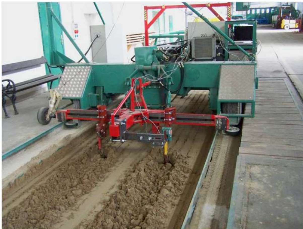
3.17. ábra: Összehasonlító vonóerőigény mérés a NAIK MGI talajvályójában
