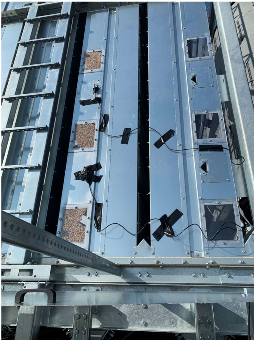
3.28. ábra: Betekintő ablakok és endoszkóp kamera szondanyílások a szárító modulon
