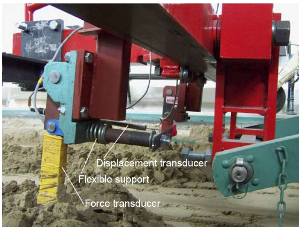
3.18. ábra: Talajművelő szerszám rugalmas rögzítése
