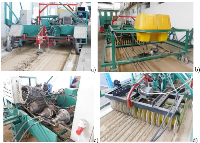
1. ábra A laboratóriumi talajvályú és mérőkocsi a) három pont függesztése, b) a nedvesítés eszközei, c) a hidraulikus hajtás és d) a vibrációs tömörítő egység.
