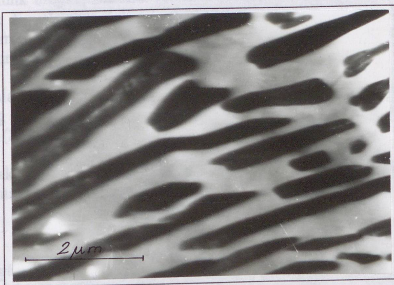
4.33. ábra. 50 %-os mértékben alakított lágyacél perlitjéről készített transzmissziós elektronmikroszkópos felvétel
