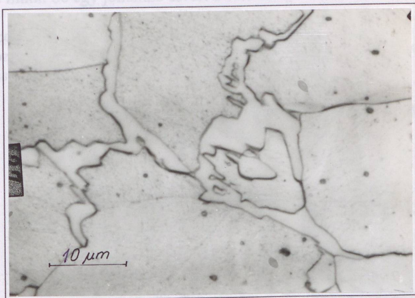
4.2. ábra. Vaskos cementitfilm ferrit szemesehatárok mentén
