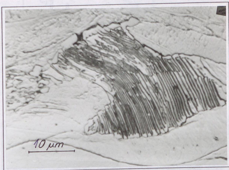
4.31. ábra. Meghajolt cementitlemezhék hidegen alakított perlitben (50 %-os fogyás)
