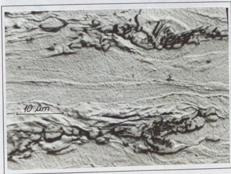
4.42. ábra. Felszakadásig hengerelt lágyacél szövete (a)
