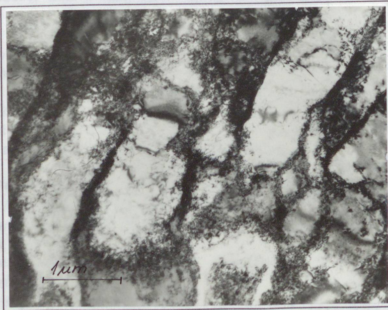
4.46. ábra. A vizsgált lágyacélok diszlokációszerkezetének változása hidegalakítás hatására
