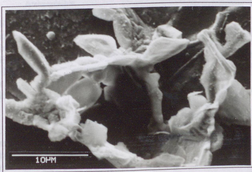
4.25. ábra. Ferrit-masszív karbidos szövetű, melegen hengerelt szalag anyagáról mélymaratott állapotban készített pásztázó elektronmikroszkópos felvételek
