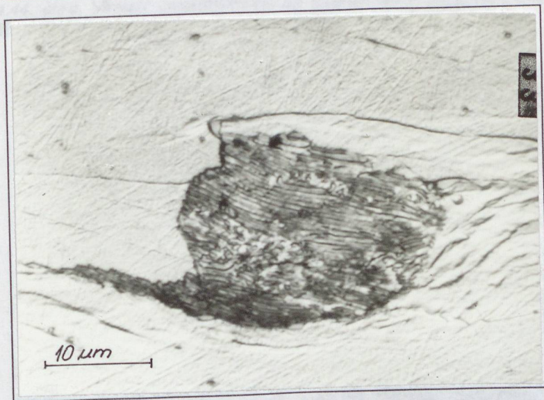
4.43. ábra. A perlitcsomó alakváltozásának jellege és mértéke közel megegyező lemeztávolság esetén a perlitet alkotó ferrit- és cementitlemezeknek a lemez síkjához viszonyított helyzetétől függ
