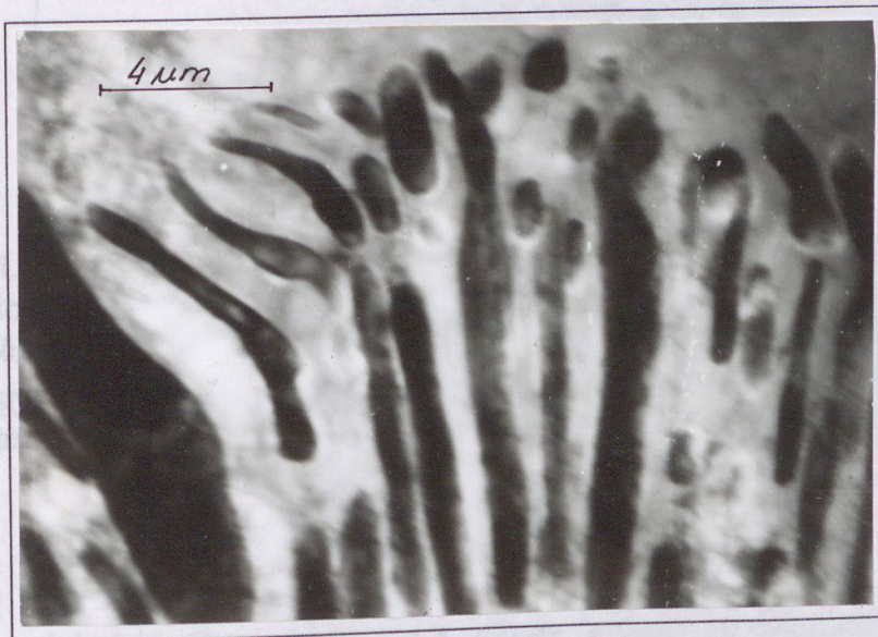
4.6. ábra. A perlitesomó és mellette levő ferrit kristallit között nincs fázishatár
