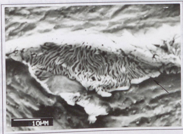
4.38. ábra. Egy masszív karbidfilmmel körülvelt perlitcsomóban a karbidból kiinduló repedések mentén létrejött repedésekről készített fény- és pásztázó elektronmikroszkópos felvétel
