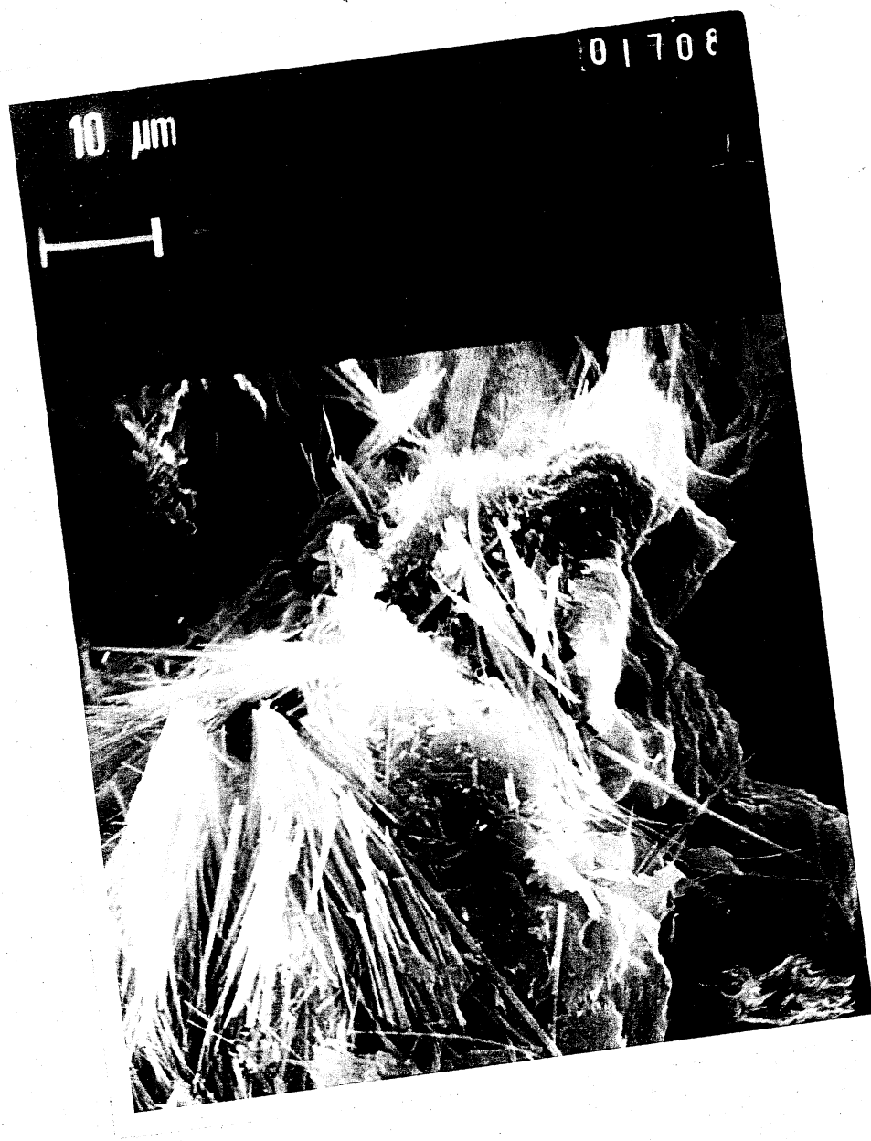
1.(b) ábra: Hazai természetes mordenittartalmu kőzet pásztázó elektronmikroszkópos képe 1150 x-es nagyításban.
