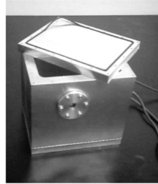
46. ábra. A diódalézer számára épített, hőmérséklet szabályzásra alkalmas foglalat (balra) és gáztömör kamra (jobbra).
