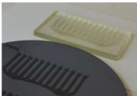
Ugyanazon AutoCAD csatornamintázatról 3D-nyomtatással, illetve a litográfias eljárással készített öntőformák (a csatornák szélessége 1 mm)
