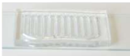
3D-nyomtatással készített öntőformáról készített PDMS mikrocsip
