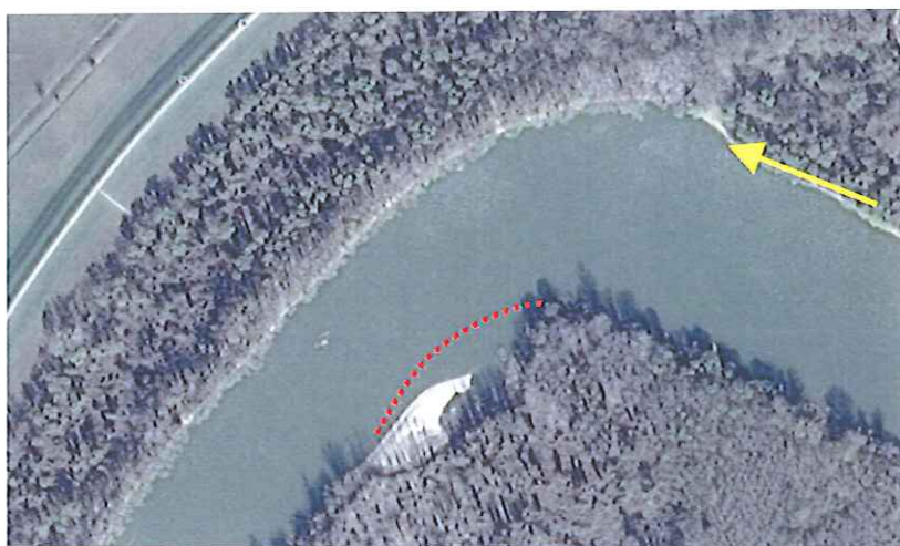
A 212.sz. VO-kőnél a szűk mederben elindult az övező mederbe csúszása (piros pötty), miközben a partbiztosítás a túlmélyített mederbe gördül, így a part hátrálni kezd (nyíl)
