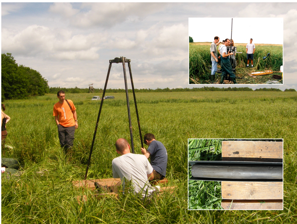
2.4. ábra A Polgár és Tiszagyulaháza községek közelében elhelyezkedő sarló-háti morotva fúrási munkálatai 2002-ben (jobb felső sarok) és 2012-ben (nagy kép). Mindkét esetben az üledék felső részét Orosz-típusú magmin-tavevővel mintáztuk, majd a talajvíz elérése után áttértünk a Livingstone-típusú fúrófej alkalmazására. A fúrások teljes hossza mindkét évben meghaladta a 7 métert. A képen jól látszik az akácós erdőfolt a feltöltődött meder partján. A kép jobb alsó felében pedig a kora-holocén üledék fotóját látjuk, mely gyors felhalmozódású, szerves anyagban szegény agyagos kőzetliszt.
