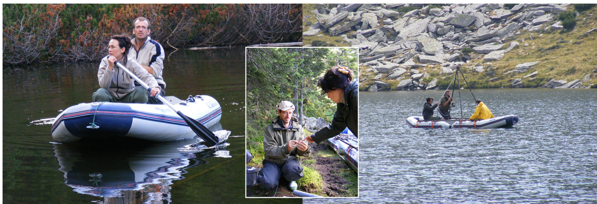
2.2. ábra A Retyezát-hegység északi lejtőin elhelyezkedő Brazi-tó (baloldal) és Gales-tó (jobb oldal) fúrásának folyamata 2007-ben. Középen a Livingstone típusú fúrófej szerelési folyamatát látjuk.
