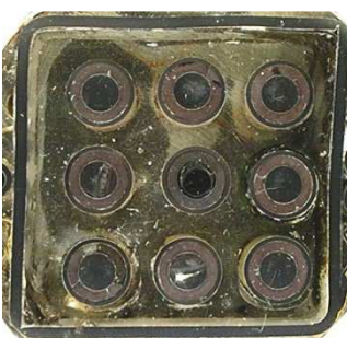
42. ábra: CODEX-AIT-1 és CODEX-AIT-2 kötegek metszetei különböző magasságokban
