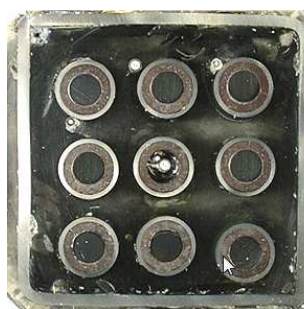
42. ábra: CODEX-AIT-1 és CODEX-AIT-2 kötegek metszetei különböző magasságokban
