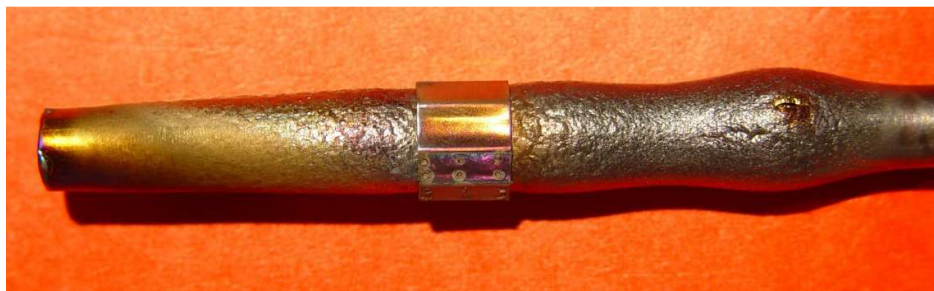
15. ábra: Kettős felfúvódás egy távtartóráccsal szerelt E110 mintán
