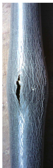
9. ábra: Előoxidált E110G mintáról készült közeli felvétel a felhasadás után (bal) és felhasadási nyomás az előoxidált E110G és E110 burkolatokkal, 800 °C-on, 0,025 bar/s nyomásnövelési sebességgel végzett felfúvódásos kísérletekben az oxidréteg vastagságának függvényében (jobb).
