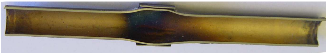
14. ábra: A távtartórács alatt felhasadt E110 mintadarab metszete
