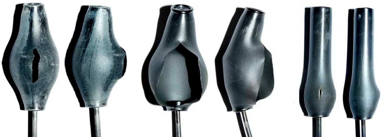
4. ábra: 700 °C-on (baloldali két kép) 800 °C-on (középső két kép) és 900 °C-on (jobboldali két kép) felhasadt E110G mintadarabokról készült fényképek
